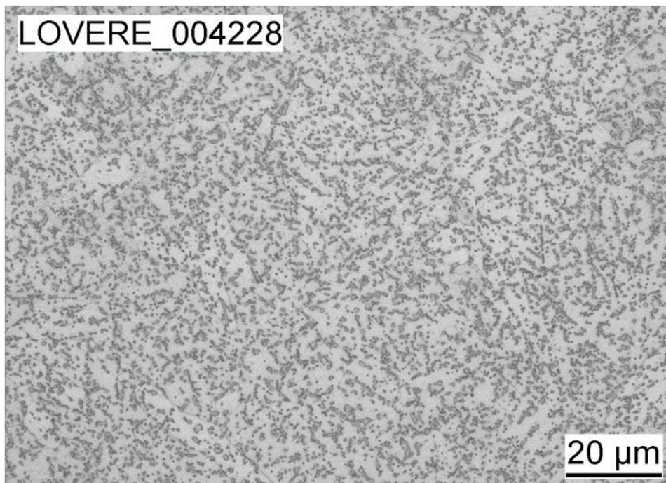
A microestrutura recozida do aço recebido é constituída essencialmente por uma matriz ferrítica com uma distribuição homogênea de carbonetos esferoidizados, quando examinada a 500X, após polida e gravada com Nital a 4%, livre de bandas excessivas.
