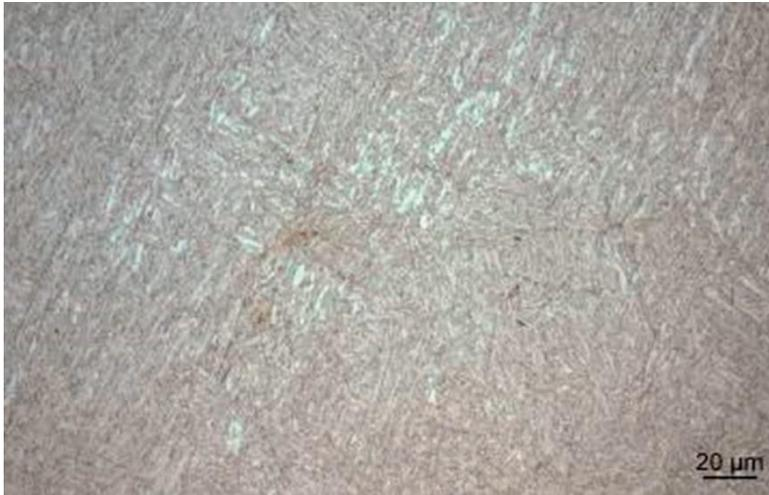
A microestrutura do KeyLos® 2002 detectada cerca de 20 mm sob a superfície é martensita revenida.
